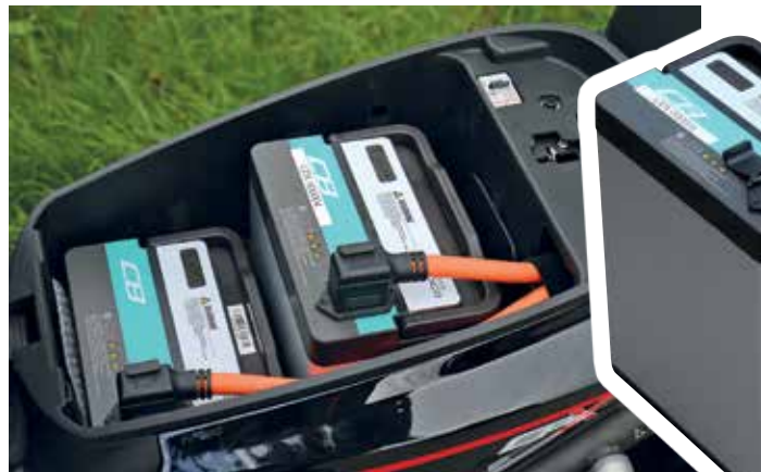
In den beiden Akkus stecken insgesamt 5,4 kWh Energie
