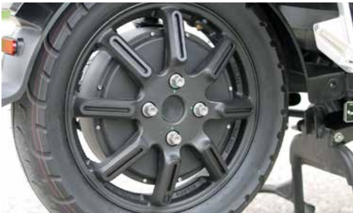
Vergleichsweise kleiner und leichter Radnabenmotor
